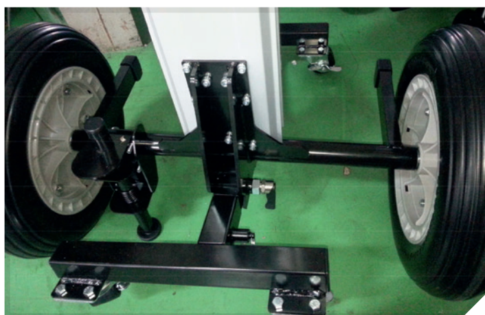
Supporto traslante a 4 ruote con freno di stazionamento
